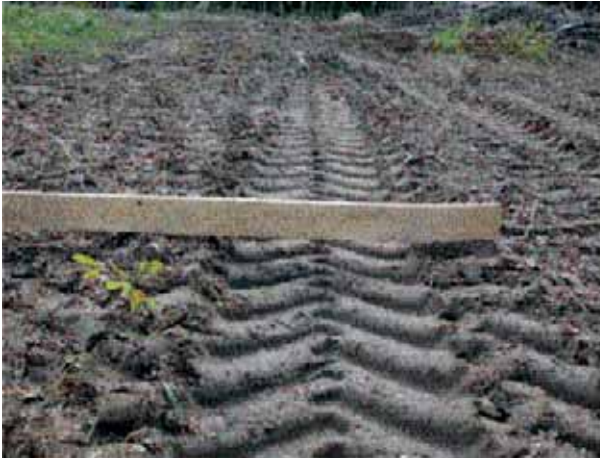
Tassement sur sol limoneux : ornierage peu profond Site expérimental GESSOL d'Azerailles (54)
