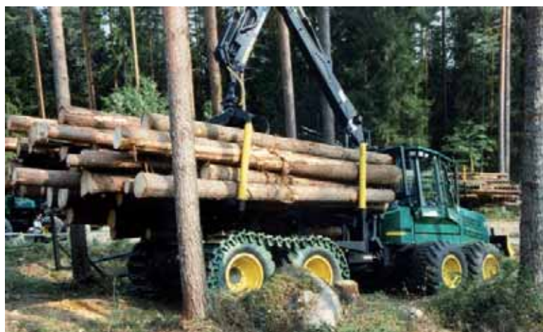
Porteur forestier équipé de pneus larges et de tracks sur les boggies arrières
