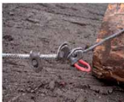
Utilisation des chokers traditionnels, avec élingues ou chaînes
