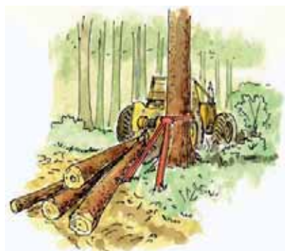
La butée de renvoi, en plus de protéger le tronc de l'arbre sur pied, protège également les racines sur un rayon de 40 cm
