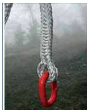
Une terminaison simple et efficace : une épissure en œillet autour d'un anneau de débardage
