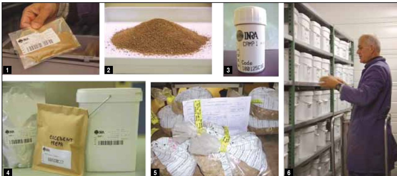
1 - échantillon issu de reliquat d'analyses, conditionné et étiqueté - 2 - sol tamisé à 2 mm - 3 - un flacon de sol conditionné pour analyse d'ADN microbien - 4 - différents contenants d'échantillons de sol utilisés au Conservatoire - 5 - échantillons issus de prélèvements de sol frais à la réception - 6 - la pédothèque
