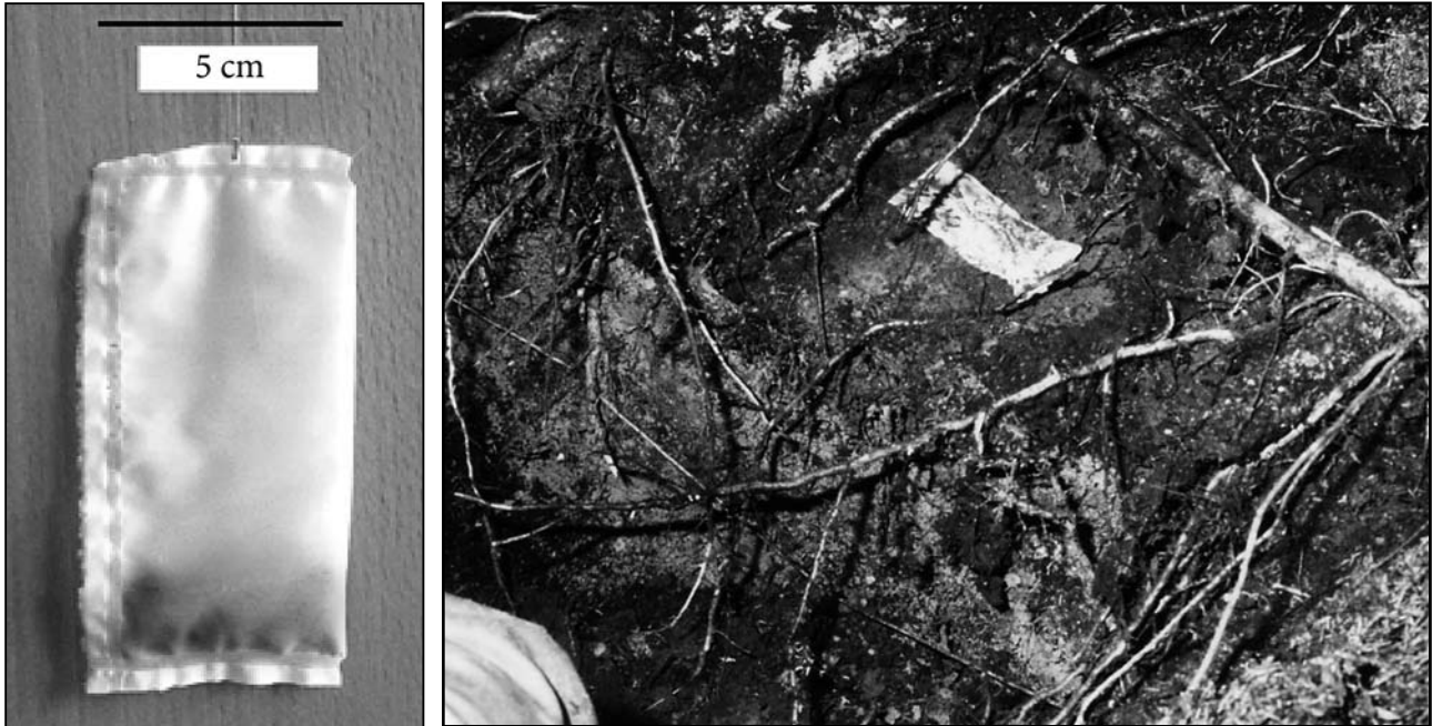
Figure 1 - Aspect d'un sachet de minéral-test avant incubation (gauche) et lors de la récolte après incubation dans le sol (droite). Figure 1 - The mineral bag before incubation (left) and during its recovery in the soil (right).
